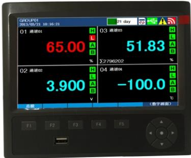
YA504R系列4路万能输入 彩屏无纸记录仪，可输入标准电流、标准电压、热电偶、热电阻等多种信号。具有传感器隔离配电输出、继电器报警输出、变送输出、历史数据转存、打印以及远程通讯功能。带标准USB2.0接口，支持优盘转存和备份历史数据。可外接微型打印机，可手动打印数据，曲线，定时自动打印实时数据，满足用户场打印的需要。广泛应用于生产设备、试验设备、过程控制所需的历史数据记录，报警记录，通断电记录，班次报表等场合。
